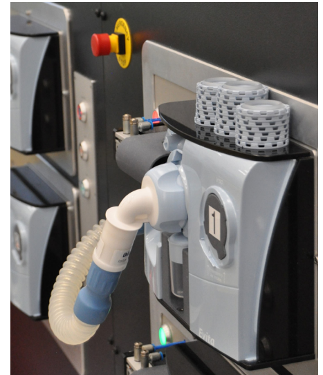
Nolato MediTor formsprutar nio komponenter i plast, TPE och silikon. Dessa monteras i en semi-automatisk monteringslinje och genomgår en allkontroll innan de packas och levereras direkt till Drägers kunder inom sjukvården.
