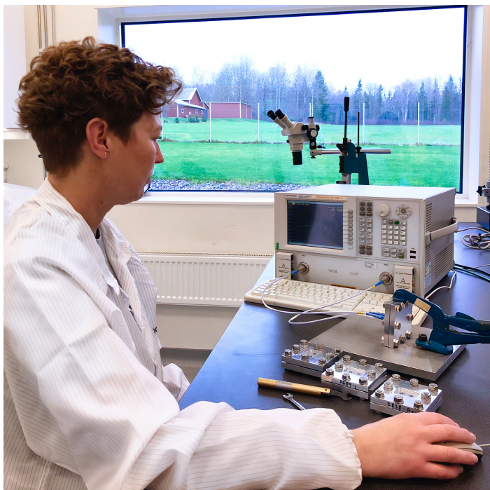
Karin Sundberg, utvecklingsingenjör på Nolato Silikonteknik, testar EMC-skärmningen.
